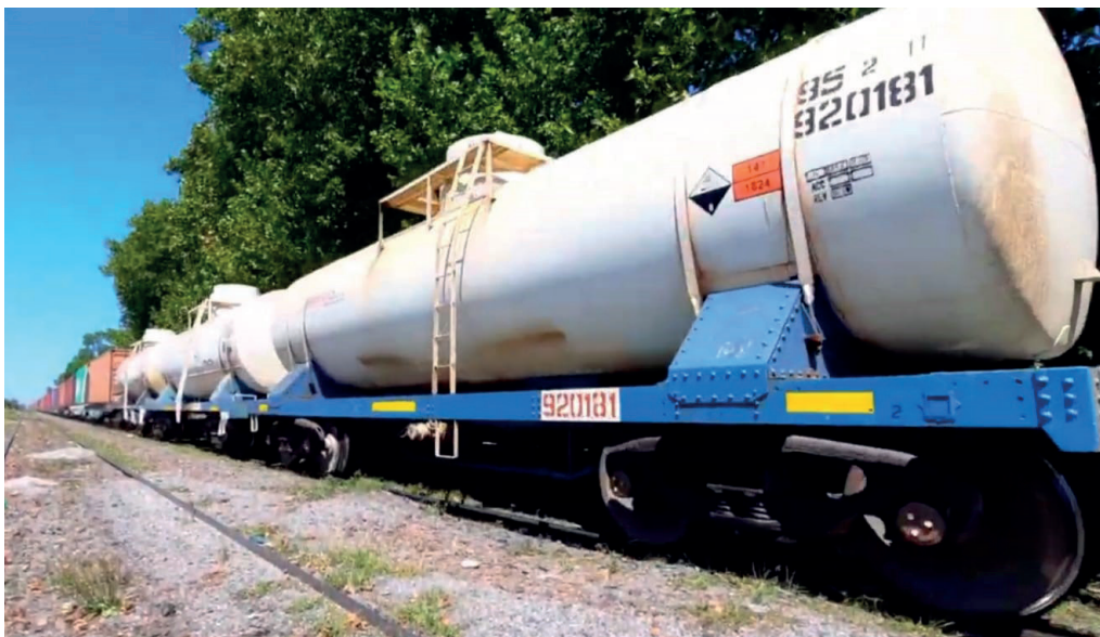
Figura 10. Estructura seguridad encima del tanque
