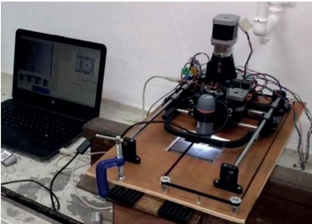
Figura 2. Vista general del dispositivo en un análisis de perfil de riel en laboratorio
