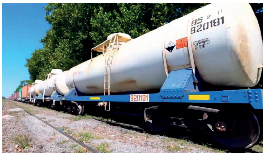
Figura 10. Estructura seguridad encima del tanque
