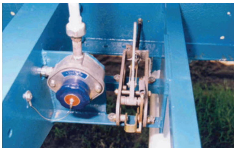
Figura 3. Acople sensor de nivel, puesta a tierra y dispositivo para válvula ventral
