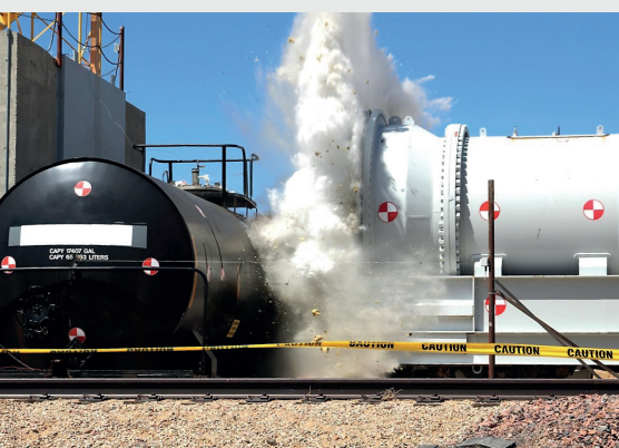
Figura 1. Muro de impacto y ram car especialmente diseñados para diversos escenarios de pruebas de colisión
